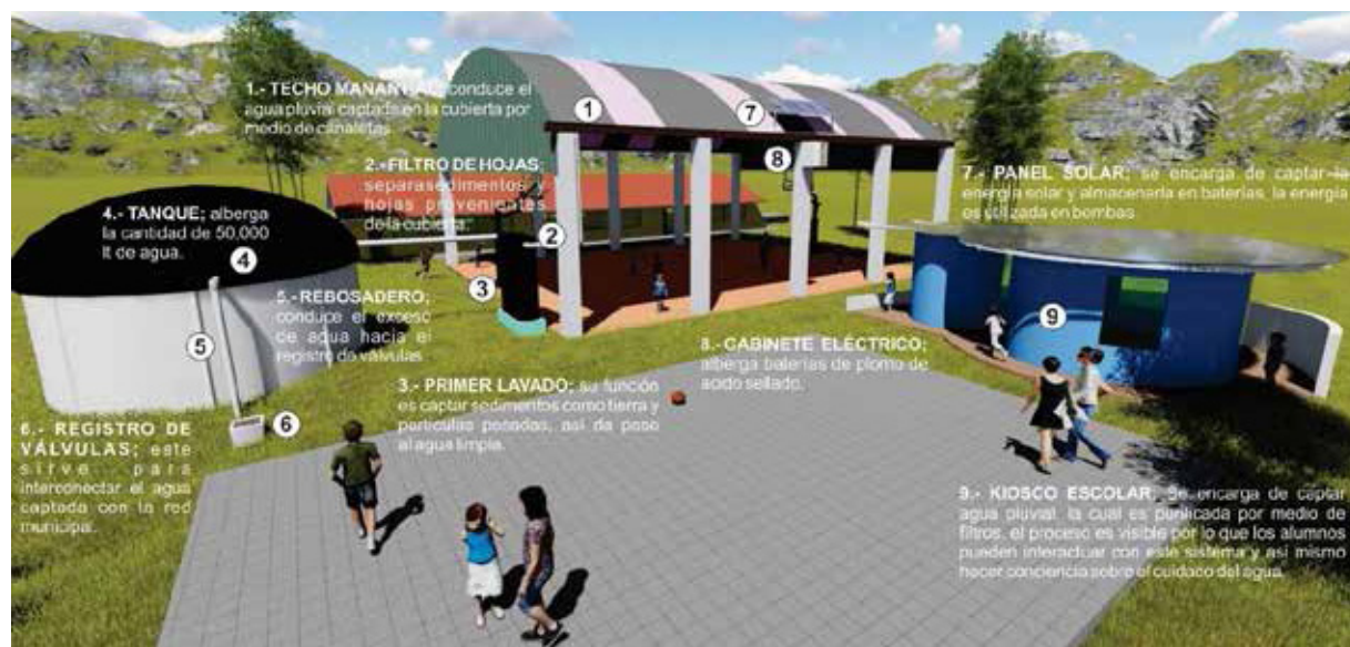
Imagen 7.2. Sistema de Captación Pluvial Neta Cero Agua y Energía con Kiosco Escolar y Planta de Purificación
