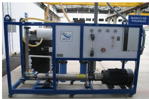
Imagen 4.1. Banco de pruebas de membranas.
